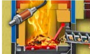
Control del lecho de brasas y combustión óptima con sonda lambda
