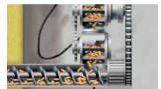
**Doble válvula rotatoria: máxima seguridad**
