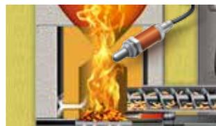
**Cámara de combustión de material refractario con sonda lambda**
