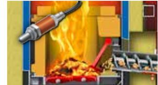
Control del lecho de brasas y combustión óptima con sonda lambda
